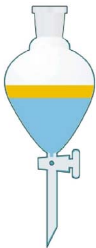
Fig.8.2 Decantador, no que se observan a separación da fracción proteica (amarelo superior) do resto dos EPM (azul inferior).
