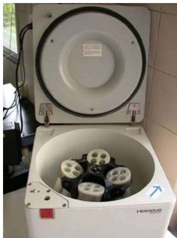
Fig.8.3 Interior dunha centrífuga, na que, ao facer xirar os tubos con EPM colocados no seu interior a unha velocidade determinada, conseguiremos separar a fracción proteica dos EPM, por mor da forza centrífuga.
